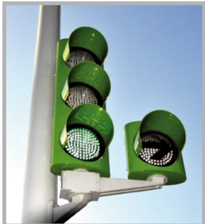
**El cuerpo Vanguard de diámetro 100 mm.** tiene como característica principal la incorporación directa de la visera en la estructura del cuerpo, y una forma posterior que permite fijar directamente el cuerpo en una columna de diámetros 100 o 114 mm con una junta de goma que se ajusta perfectamente a la superficie.
